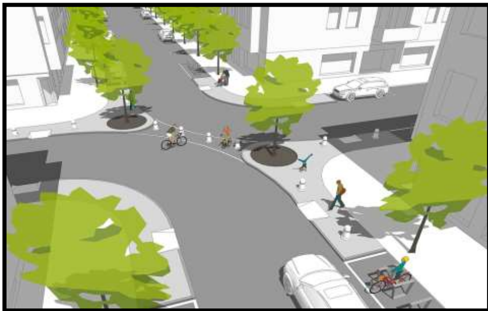
Abbildung 7: Modale Filter durch bauliche Sperren© ADFC/Tim Schwendy
