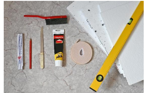
Abbildung 1: Du brauchst einen Gliedmaßstab, einen Stift und einen langen, geraden Gegenstand. Handfeger, Lappen und Messer. Montagekleber oder doppelseitiges Klebeband. Dämmplatten. Und ein selbstklebendes Schaum- oder Schlauchband für die Abdichtung.
